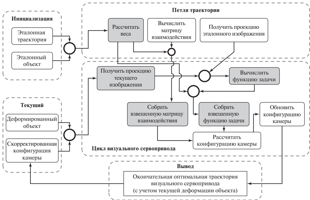
Рис. 1. Блок-схема алгоритма визуального сервопривода на основе треугольных сеток для деформируемых объектов.
